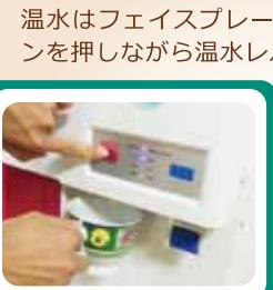
温水はフェイスプレートにあるチャイルドロックボタンを押しながら温水レバーを押してください。
